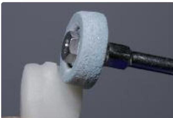
Сглаживание мест прикрепления литников с низкой скоростью и легким давлением, обработка поверхности
