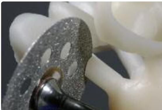
Отрезание литников с помощью тонкого алмазного диска, место отреза постоянно увлажняется
