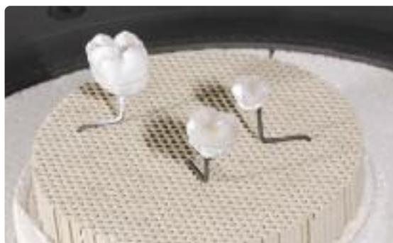
обжиг глазури проводится с соответствующими параметрами обжига на трегере с сотовой структурой.
