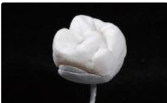
В качестве альтернативы пастообразной глазури можно использовать глазурь-спрей IPS e.max Ceram Glaze Spray. Глазурь-спрей IPS e.max Ceram Glaze Spray напылить равномерным слоем. Внутреннюю поверхность закрыть
