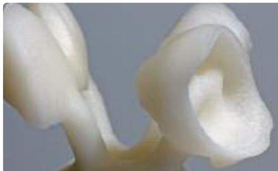
Удалите реакционный слой, образовавшийся на отпрессованных объектах, жидкостью Invex в ультразвуковой ванне.
