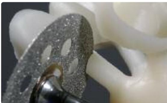
Отрежьте литники с помощью тонкого алмазного диска при постоянном увлажнении места отреза.
